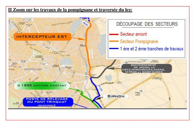
→ Pose de 2200 ml de canalisation en Béton diamètre 1200 mm par la technique du microtunnelier sous l'avenue de la Pompignane et réalisation d'un siphon en traversée du lez à proximité du pont André Levy
