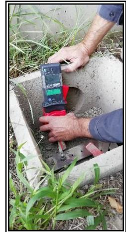
*Mesure de la terre au telluromètre en date du 30 septembre 2021*
