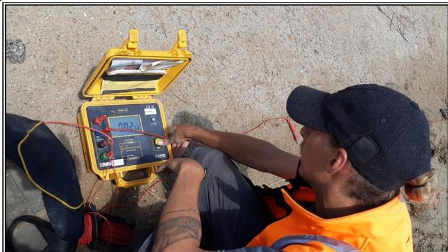
*Mesure de corrosivité sur le tronçon lagunaire*
